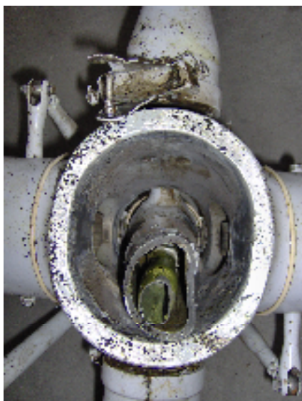
Сл. 4 Детаљ прелома вратила (погонског и за промену скупног корака) на главчини главног ротора хаварисаног хеликоптера
